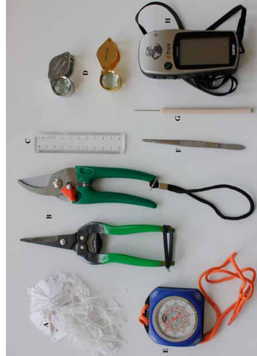
Şekil 4.2 Tohumusuz bitkilerin doğadan toplanmasında kullanılan bazı alet ve malzemeler A, Etiketler; B, Budama makası; C, Cetvel; D, Luplar (Büyüteçler); E, Altimetre (Deniz seviyesinden yükseklik ölçer); F, Pens, G, Diseksiyon iğnesi; H, GPS cihazı. (Fotoğraf: Tamer KEÇELİ)
