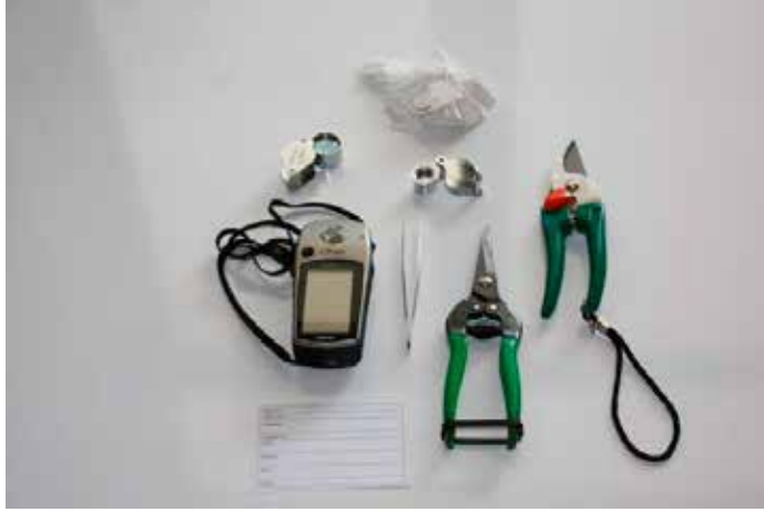
Şekil 4.20 Tohumlu bitkilerin toplanmasında kullanılan gereçler: GPS, luplar, etiketler, pens ve budama makasları.
